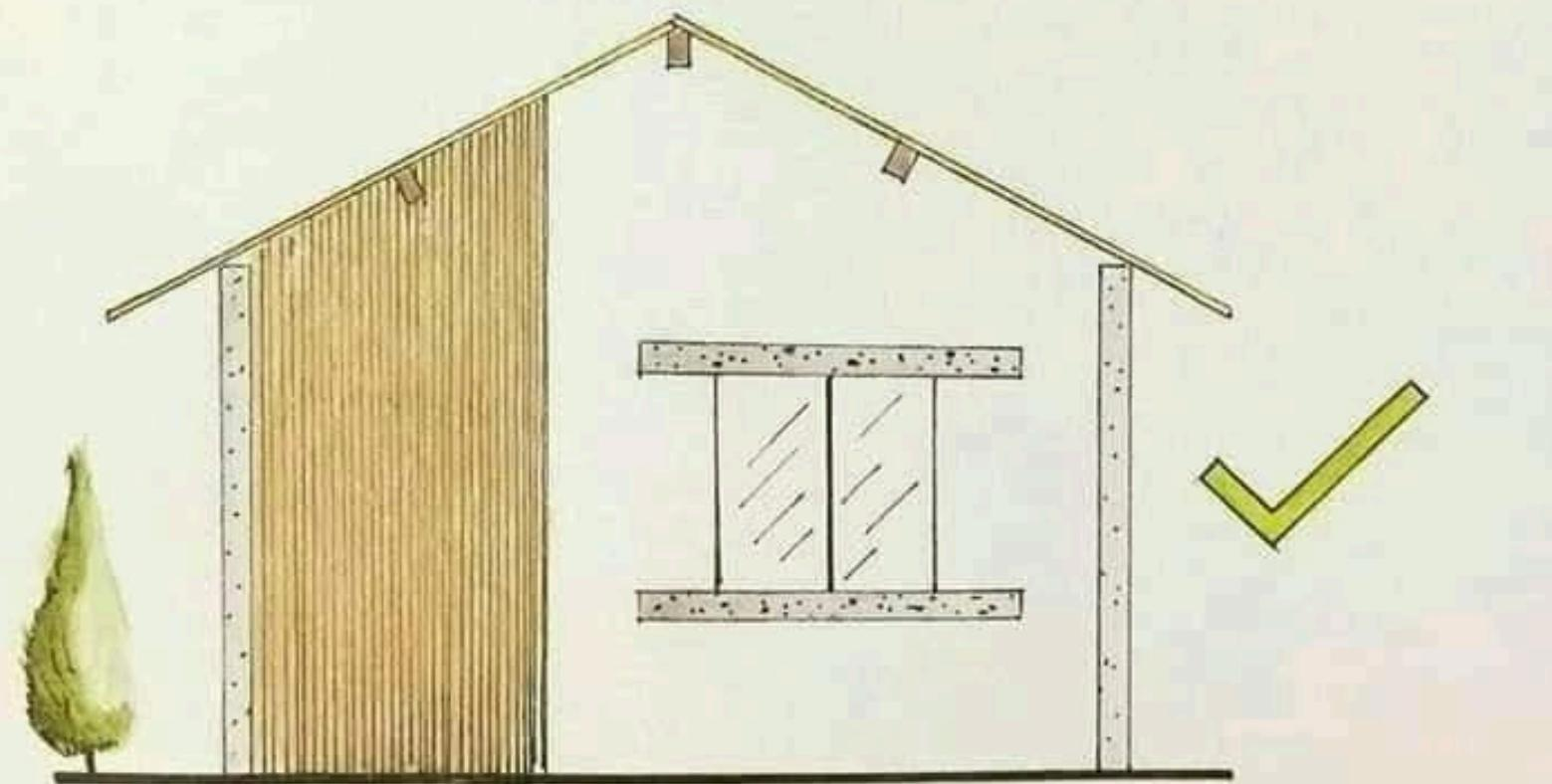
Lintel adalah element penting dalam pembinaan rumah kerana ia membantu menyalurkan beban Dari atas ke struktur di bawah. Tanpa lintel yang sesuai, struktur boleh mengalami kerosakan. Pelbagai Jeni's lintel digunakan kepada bahan binaan Dan rekabentuk bangunan. Pemasangan 2 lapis lintel dapat mengurangkan risiko keretakan pada dinding bahagian tingkap bangunan.
